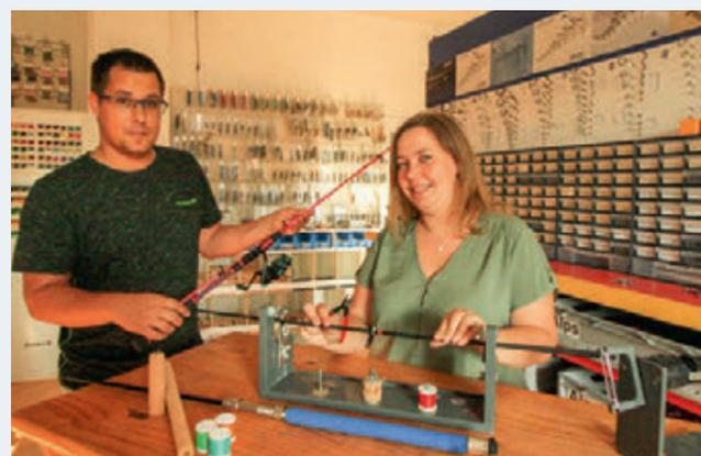
Melanie und Sebastian Kiebigst am Rutenbau-Bock. Dort wird der Blank (die rohe Rute) eingespannt. Mit verschiedenfarbigem Garn werden Zierwicklungen gelegt, Ösen und Ringe befestigt. Zum Schluss erhält das gute Stück eine Lackierung.
